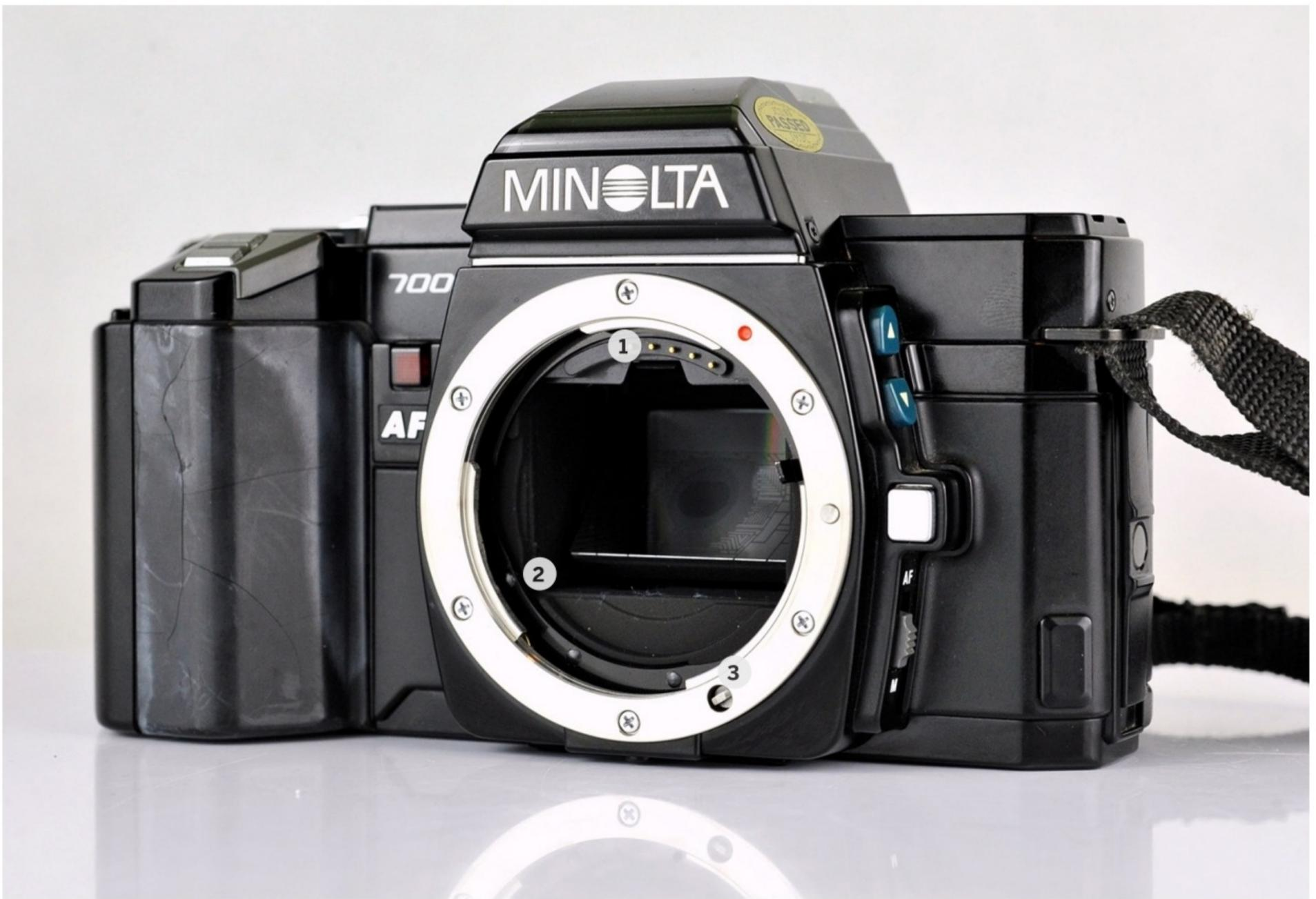
Le Minolta 7000, premier reflex autofocus commercialisé avec une vaste gamme optique, intégrait déjà des contacts électriques dans sa nouvelle monture, ❶ mais disposait aussi d'une liaison mécanique pour l'ouverture ❷ et surtout pour l'autofocus, le moteur intégré au boîtier actionnait une pièce qui faisait varier la mise au point de façon mécanique à l'intérieur de l'objectif ❸.
