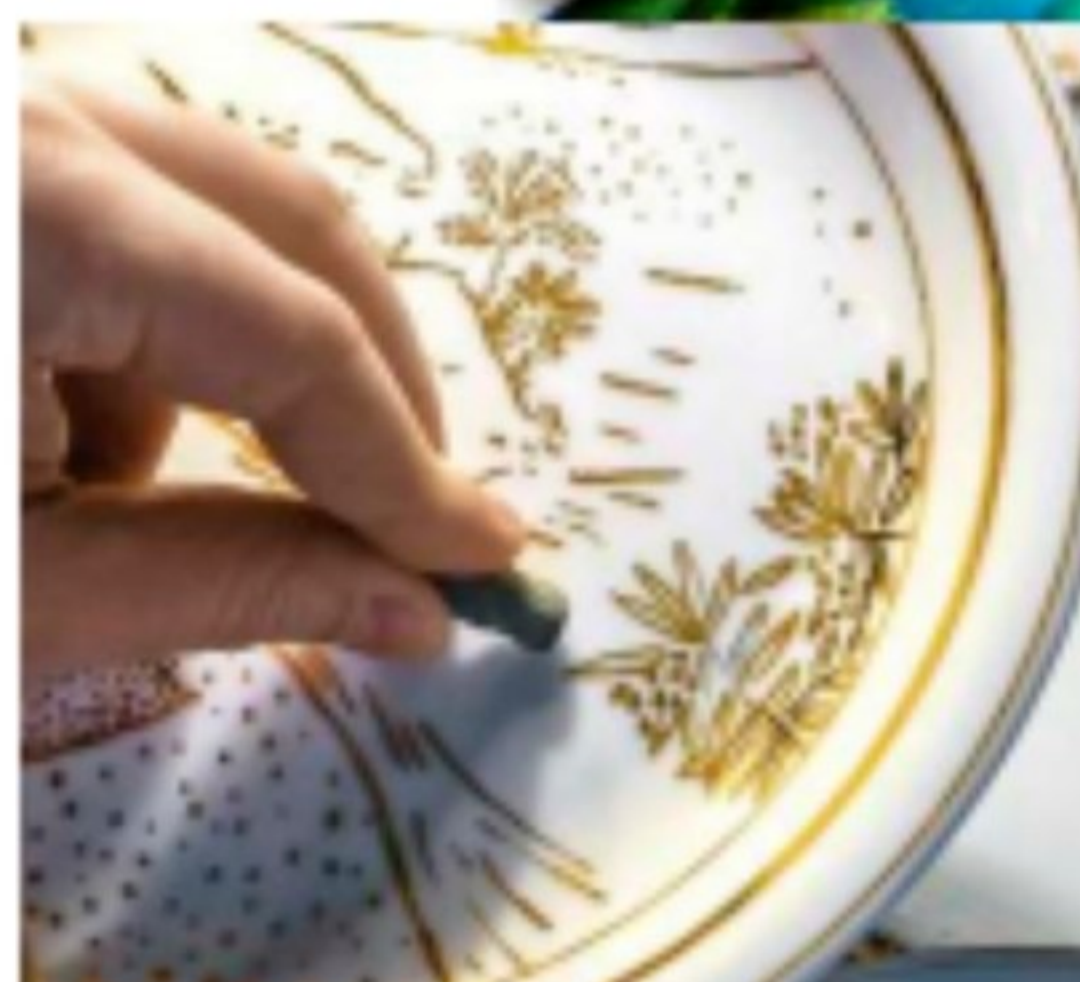
☛ Gommage de projections d'or apparues après cuisson.
