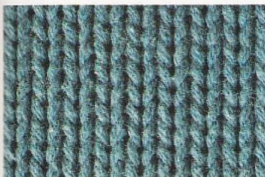
Les tricots sont des tissus à fils accrochés. Les **CÔTES** sont des colonnes de mailles disposées sur la longueur et les **RANGS**, des colonnes sur la largeur. Les premières correspondent à la chaîne et les secondes, à la trame.
