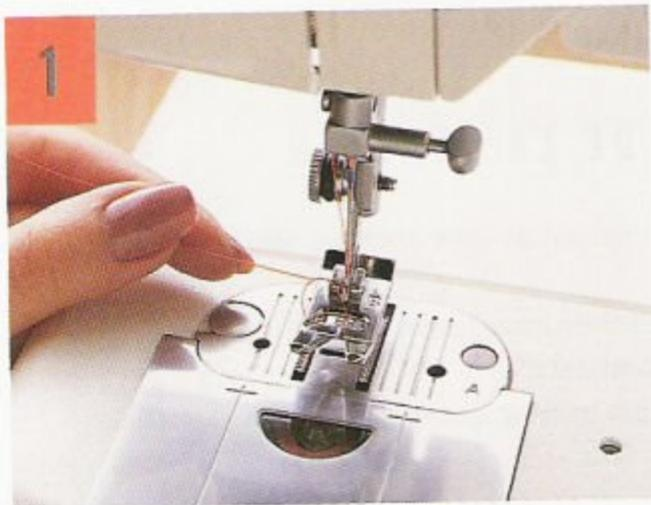
**1** Enfilez votre machine (p. 14) et mettez la canette dans la navette (p. 13). Tout en tenant le fil de la main gauche, faites tourner le volant vers vous jusqu'à ce que l'aiguille soit descendue et revenue à sa position la plus élevée. Un point se formera et vous sentirez une tension sur le fil de la bobine. Tirez sur ce dernier pour amener le fil de la canette à sortir du trou de la plaque à aiguille. Tirez sur les deux fils en même temps sous le pied-de-biche et vers un des côtés.
