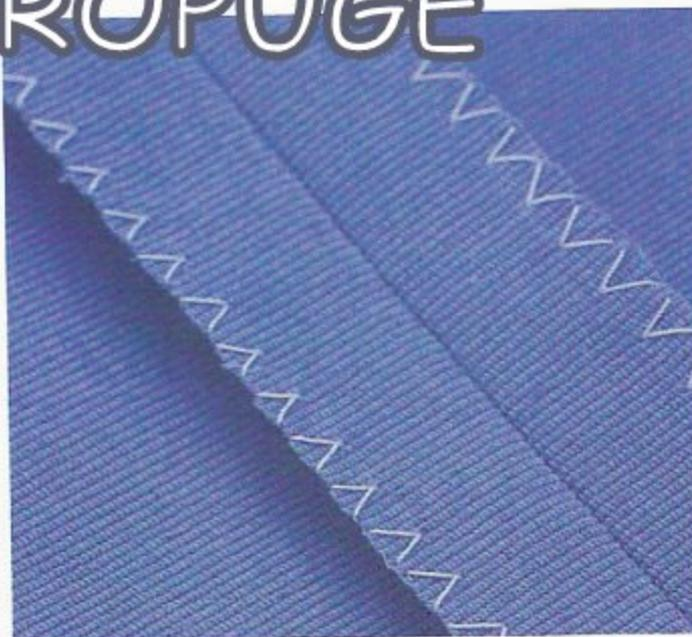
**Point zigzag.** Réglez le point zigzag à la largeur maximum ou presque et à une longueur de 2,5 mm (10 points au pouce). Piquez près du bord de chaque ressource de couture de façon que les points allant vers la droite passent juste par-dessus le bord du tissu. Si le tissu plisse, essayez une largeur moindre.
