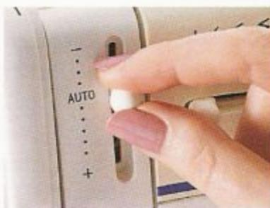
Une fois ces vérifications faites, vous aurez peut-être besoin de régler la tension sur votre machine. (Consultez le manuel du fabricant.) Augmentez ou diminuez légèrement la tension du fil de la bobine pour que les tensions des fils de canette et de bobine
