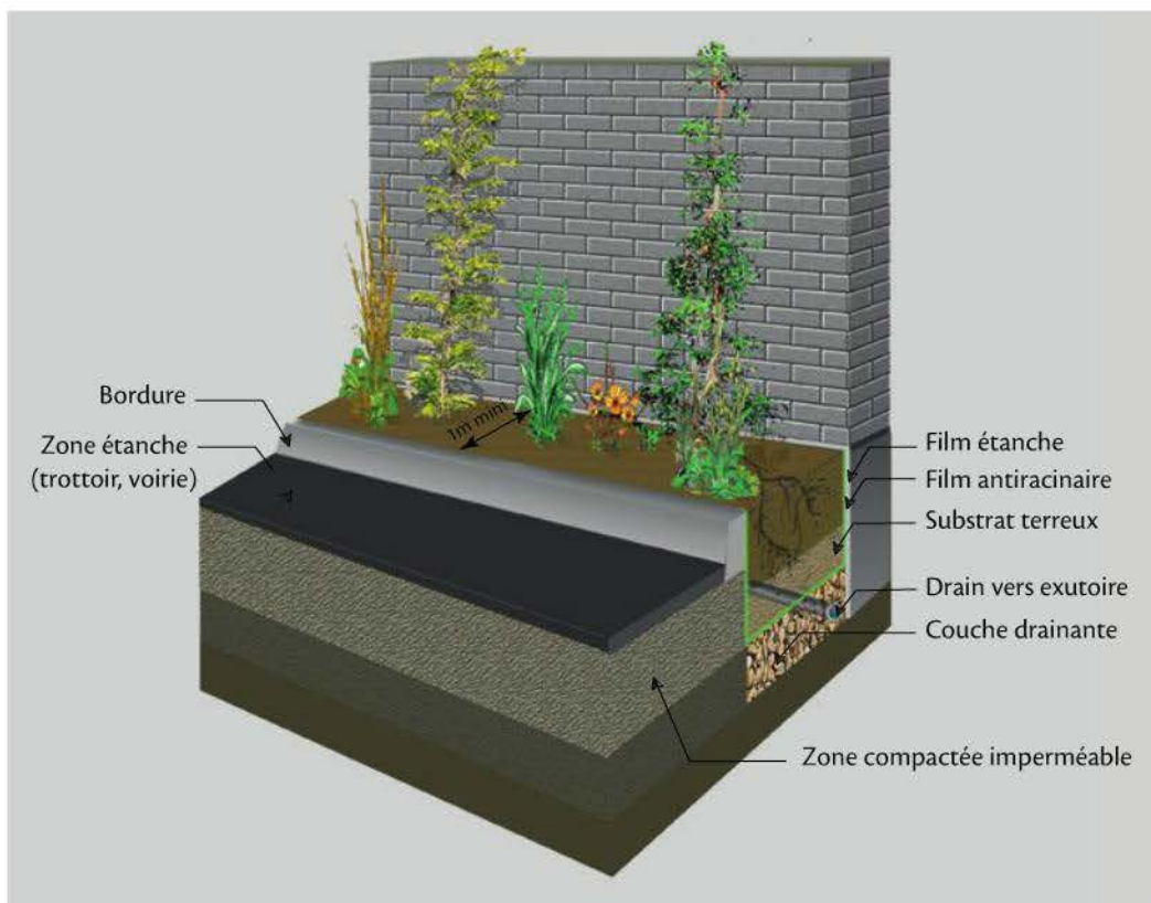
Figure 1 : Tranchée en pleine terre
