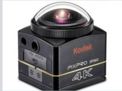
L'Américain JK Imaging a sorti, sous licence Kodak, la caméra PixPro SP360-4K, une évolution du modèle actuel qui apporte la définition 4K pour les images fixes et vidéo. Cette caméra ultra-grand-angle possède un capteur BSI CMOS de 12 MP et un objectif f:2,8 sphérique. Elle est livrée avec un logiciel qui convertit les séquences enregistrées dans le format vidéo à 360 degrés de YouTube. [www.kodakcamera.jkilt.com](http://www.kodakcamera.jkilt.com)
