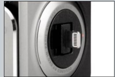
L'architecture du connecteur Lightning pivotant a été soignée (disjoncteur mécanique) afin de ne faire courir aucun risque à l'iPhone.
