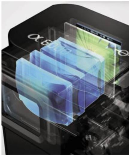
L'oculaire d'un EVF est semblable à celui d'un OVV (Optical View Finder) mais ce système optique agrandit l'image d'un minuscule moniteur et non l'image (optique) formée sur un dépoli.
