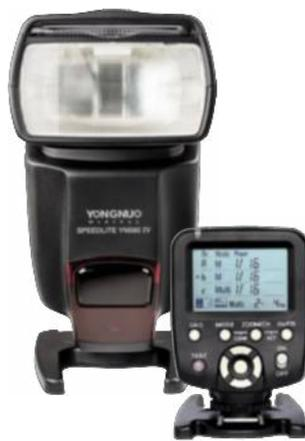
Comme le Cactus RF60, cette quatrième génération du YN560 ne gère pas la TTL. Elle est en revanche dotée d'un émetteur/récepteur HF lui permettant de piloter (portée d'environ 100 m dans des conditions idéales) 3 groupes d'autres 560. Le
