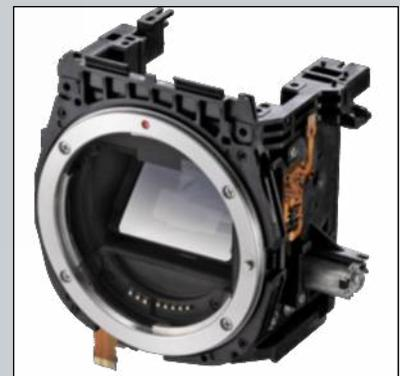
À l'intérieur, il n'y a pas que le capteur qui soit nouveau : le mécanisme du miroir a été amélioré pour limiter les vibrations, critiques à ce niveau de définition. Un moteur le freine en fin de course.
