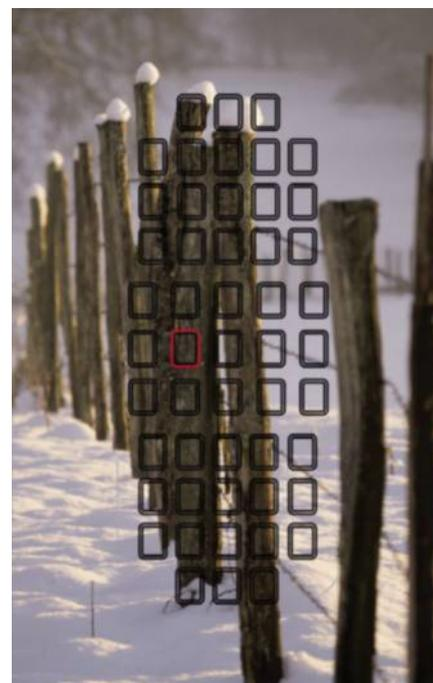
Dans le viseur, les "collimateurs" sur lesquels l'autofocus peut effectuer la mise au point s'affichent. On peut choisir celui que l'on veut sélectionner avant d'actionner le système.
