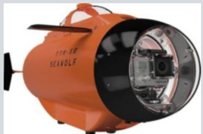
Conçu par ROV TTRobotix, le Seawolf est un drone sous-marin capable de descendre jusqu'à 30 mètres de profondeur et d'y capturer des images fixes ou animées grâce à sa caméra GoPro embarquée. Ce "loup de mer" se pilote simplement en FPV (First Person View). Il pèse 7,7 kg, mesure 75 cm de long et avance à 3,3 km/h. Tarif non encore communiqué. [ttrobotix.com](http://ttrobotix.com)
