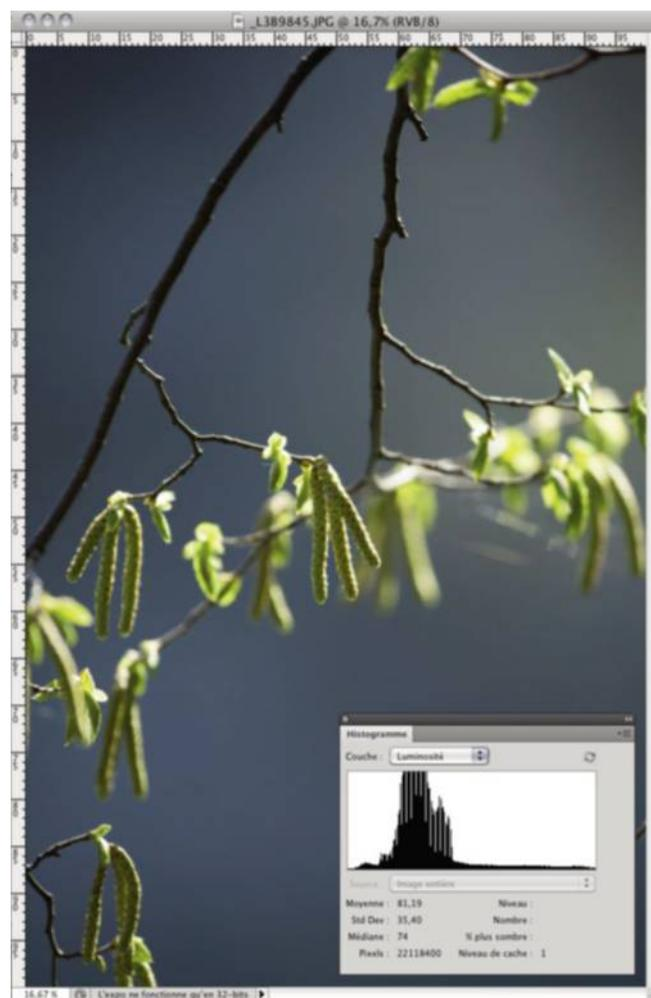
Quand le sujet est flou, le contraste global est plus faible. Ce dernier est maximal lorsque l'image est nette. L'autofocus à détection de contraste procède par tâtonnement pour maximiser le contraste et obtenir l'image la plus nette possible.
