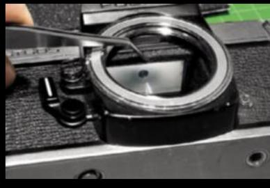
Les kits pour reflex contiennent également la mousse d'amortissement du miroir, qu'il faut précautionneusement positionner en place à l'aide de pinces brucelles.
