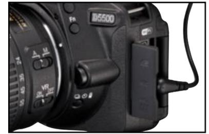
Les connectiques sont complètes, avec en plus de l'USB/vidéo, une prise pour télécommande filaire, et une entrée micro. La prise HDMI est de l'autre côté. Il manque juste une sortie casque pour la vidéo.
