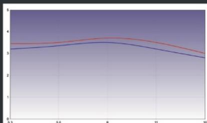
**100 mm:** Le piqué baisse globalement mais devient très homogène. Il progresse très peu, au centre comme sur les bords. La distorsion est moins visible (1,5 % en coussinet) et l'aberration chromatique est quasi-nulle (0,1 ‰). Le vignetage est peu sensible (0,5 IL à pleine ouverture).
