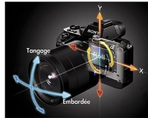
La stabilisation du navire A7 II gère les mouvements de translation, roulis, tangage et embardée. Ces deux derniers mouvements angulaires sont pris en charge par l'objectif lorsqu'il dispose d'une stabilisation optique OSS.
