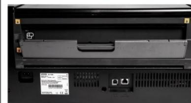
La trappe arrière de l'imprimante est ici dégagée pour l'utilisation des papiers en chargement frontal. On distingue le câble d'alimentation (à gauche), le câble USB (à droite), et la prise Ethernet.
