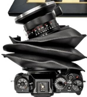
La diagonale du flou! La bascule latérale m'a permis de placer le plan de mise au point sur la diagonale de l'échiquier. C'est ce mouvement qui est le plus délicat à régler, l'écran dorsal ou l'EVF n'offrant évidemment pas la même précision de contrôle qu'un compte-fils sur un dépoli.
