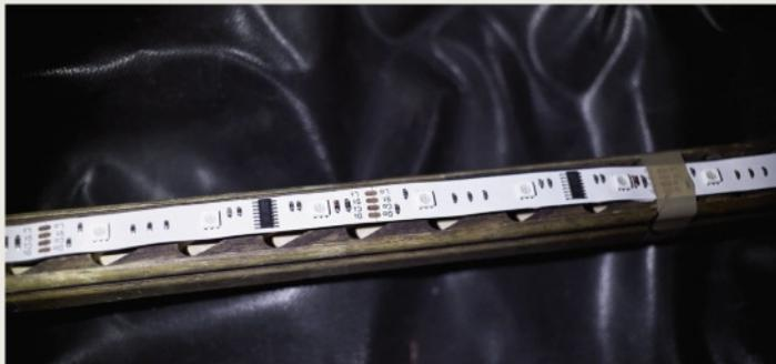
**1** Pour cette prise de vue, Alexis a choisi d'utiliser la barre de LED qu'il a construite lui-même. Elle se compose d'un ruban de 45 LED RVB fixées sur un support en bois et reliées à un boîtier de programmation qui permet de faire varier la couleur, l'intensité, la séquence et la vitesse d'allumage. Coût: 100 €.
