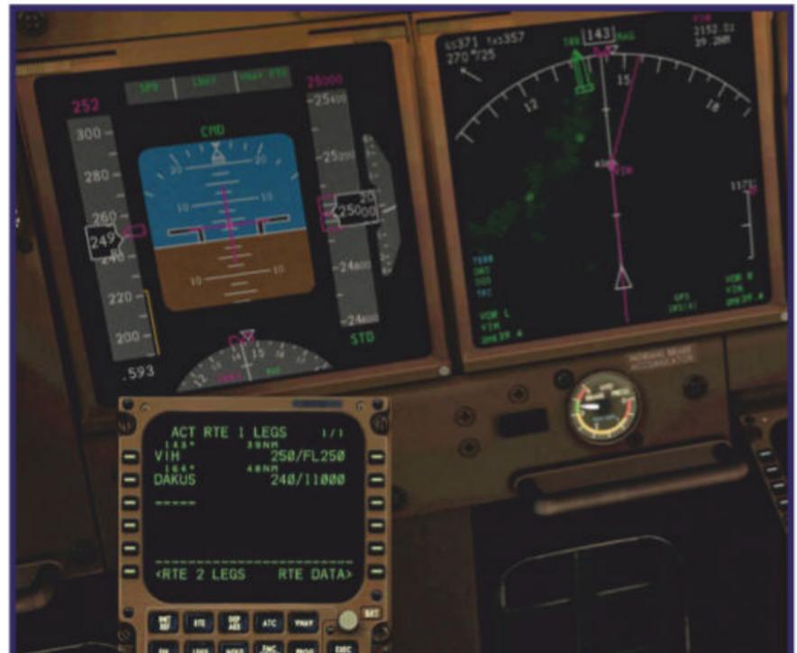
Fig. 9: Les altitudes et vitesses sont ajoutées manuellement pour les points VIH et DAKUS, alors qu'on se dirige vers le premier.
