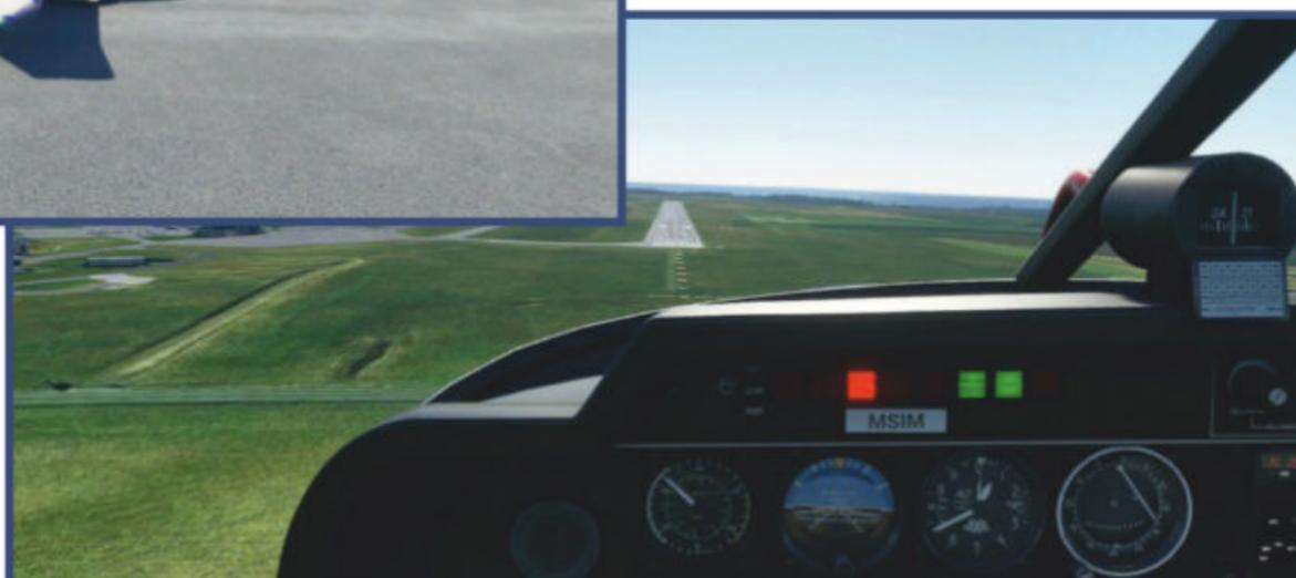
Fig. 26: En finale dans le bon plan de descente, à en croire les feux PAPI.
