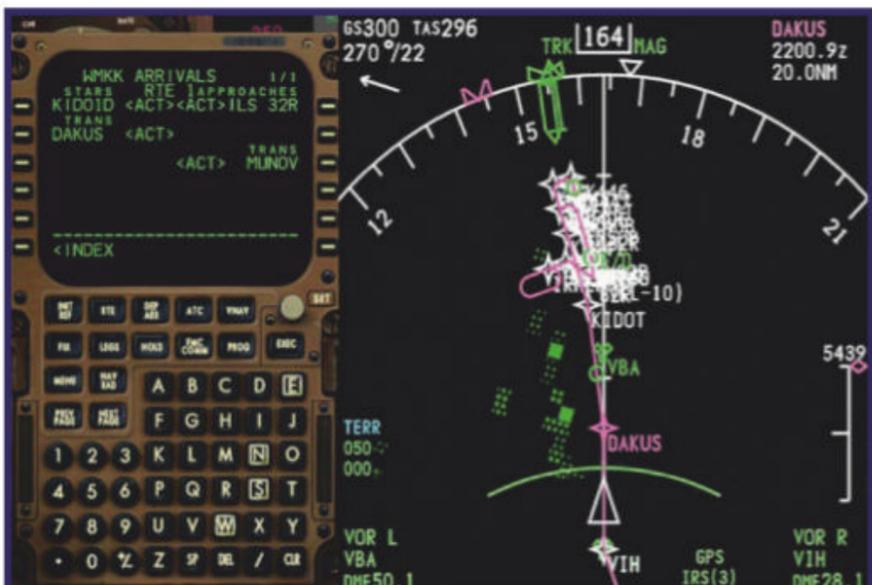
Fig. 10: La STAR est sélectionnée avec ses deux transitions successives dans le CDU, la trajectoire s'affiche dans le ND – mais avec une portée de 160 nm, les informations y sont difficilement lisibles !
