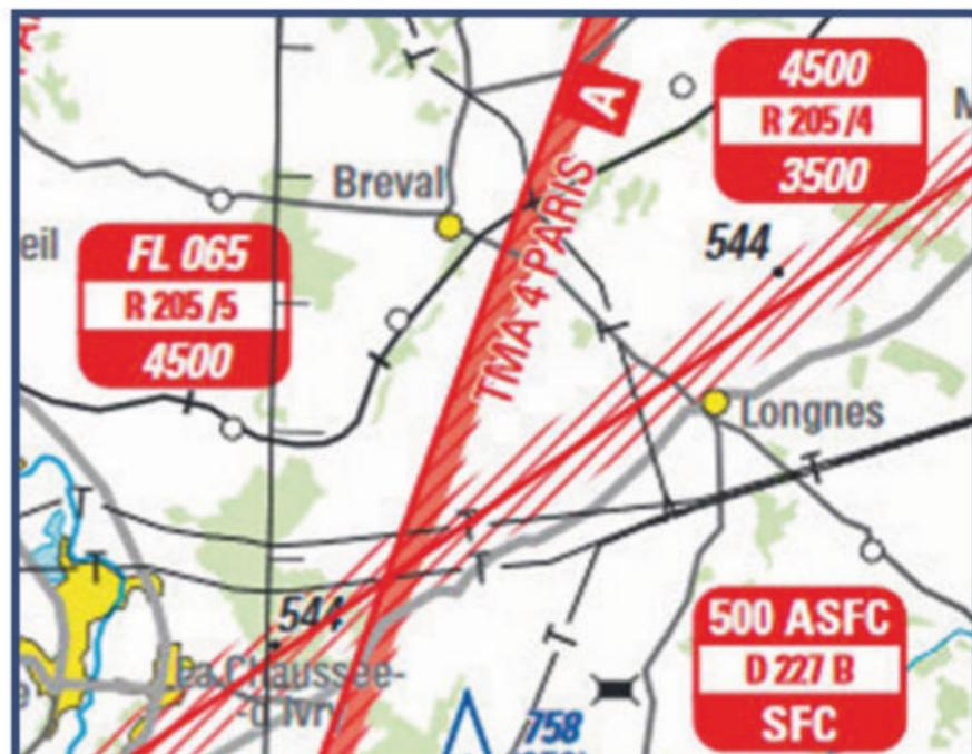
Fig. 6: Les avertissements impliquent de se reporter au document « Complément VFR » du SIA: il décrit les conditions particulières entre les deux altitudes mentionnées (ici par exemple entre 4500 et 6500 ft, 3500 et 4500 ou le niveau du sol SFC et 500 ft).
