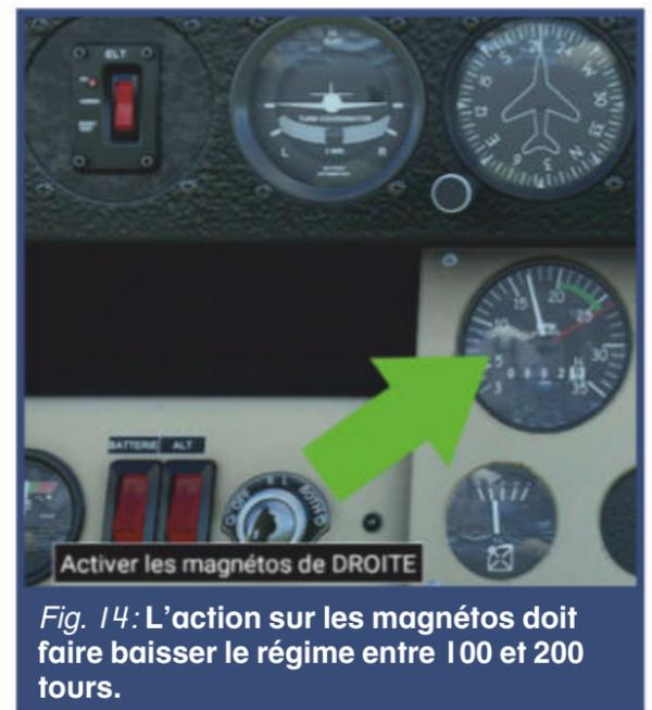
Fig. 14 : L'action sur les magnétos doit faire baisser le régime entre 100 et 200 tours.
