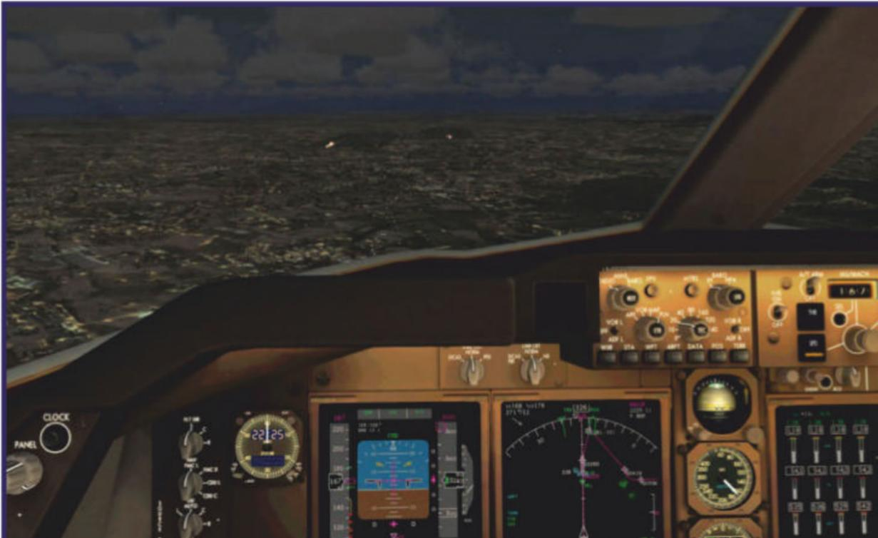
Fig. 12: Le PA en mode APP (roche) suit impeccablement l'axe et le plan de descente. N'oubliez pas le train ni les volets !
