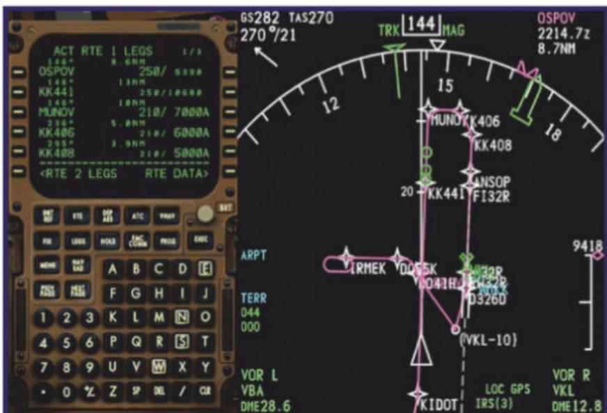
Fig. 11 : Chaque point de la STAR a ses vitesses et altitudes propres, ajustées par le mode VNAV du PA, plus on se rapproche de l'arrivée, plus on peut zoomer sur le ND pour visualiser la trajectoire.
