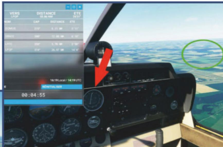
Fig. 21: Le VOR nous indique la radiale 56° d'EVX (rouge), les éoliennes sont bien là (vert), et le chrono ne dépasse nos prévisions que de 10 secondes: la navigation a été bien menée sur ce segment.
