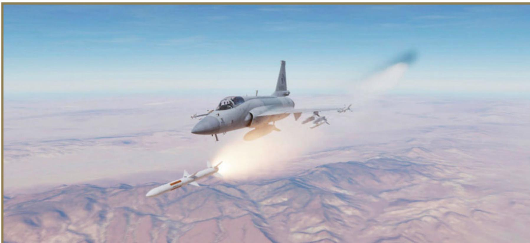
Tir d'un missile SD-10 par le Thunder : ce missile air-air à guidage radar actif est plus performant que l'AIM-120C.
