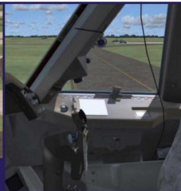
Fig. 3a & 3b : Tourner au sol dans un géant n'a rien de simple : la direction à suivre doit apparaître dans la fenêtre latérale. On s'aide à la fois de la roulette avant directrice et du freinage différentiel.
