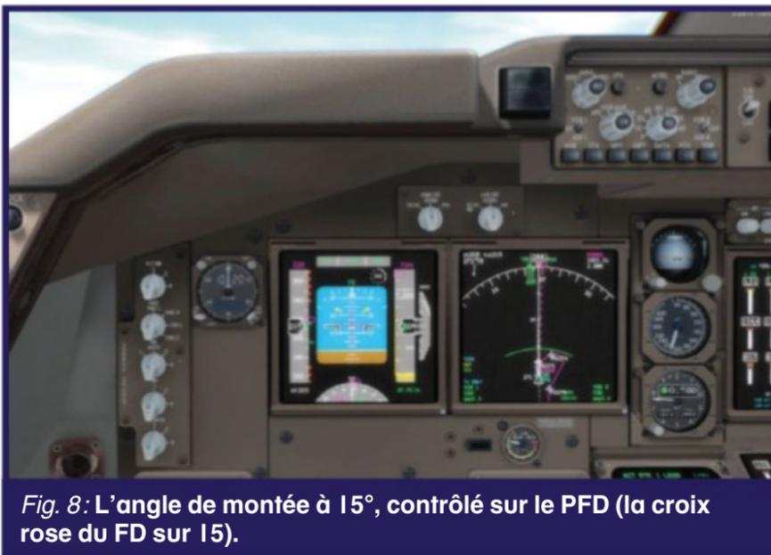
Fig. 8: L'angle de montée à 15°, contrôlé sur le PFD (la croix rose du FD sur 15).
