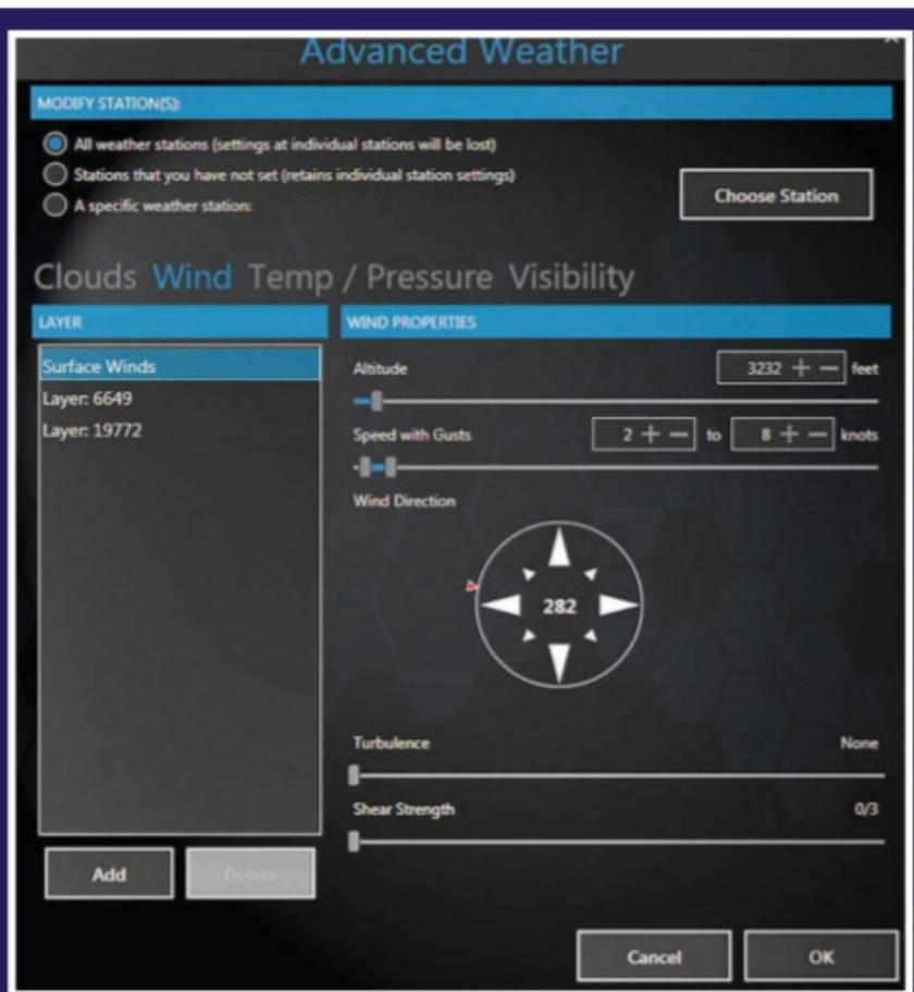
Les réglages météo de P3D, plus particulièrement le vent : la direction est celle d'où vient le vent, pas vers où il souffle.
