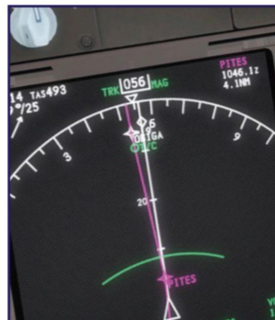
Fig. 13 : Le pic de montée (Top of Climb ou T/C) est modélisé par un cercle vert sur le ND.
