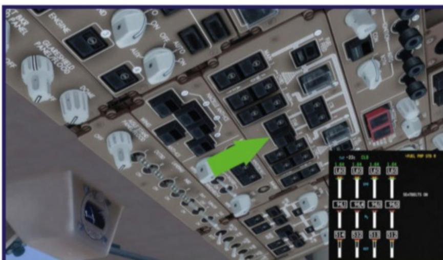
Fig. 14 : La pompe du réservoir stabilisateur gauche a été activée, celle de droite est encore inactive et une alerte en ambre le signale sur l'EICAS.
