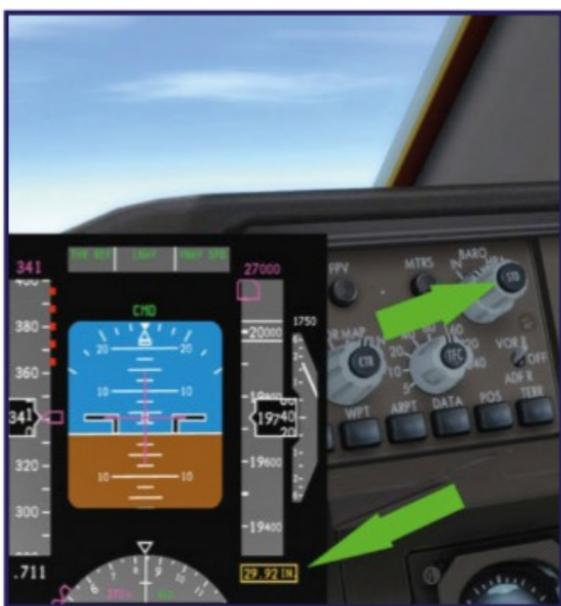
Fig. 11 : Quand on passe les 18 000 ft, la pression atmosphérique sur le PFD s'affiche en ambre ; il faut basculer en mode Standard en pressant le bouton de réglage de l'altimètre barométrique.
