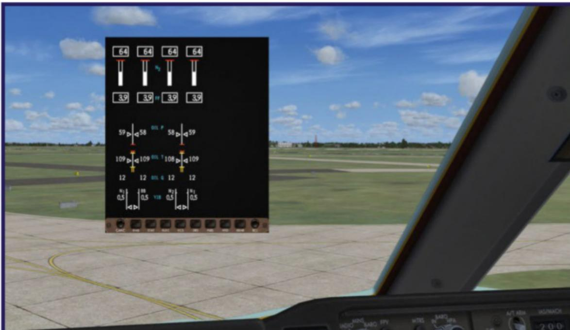
Fig. 1 : L'affichage de la température d'huile sur l'EICAS inférieur, à la ligne Oil T : les valeurs ne correspondent pas au manuel, mais les aiguilles sont dans la zone blanche « acceptable ».
