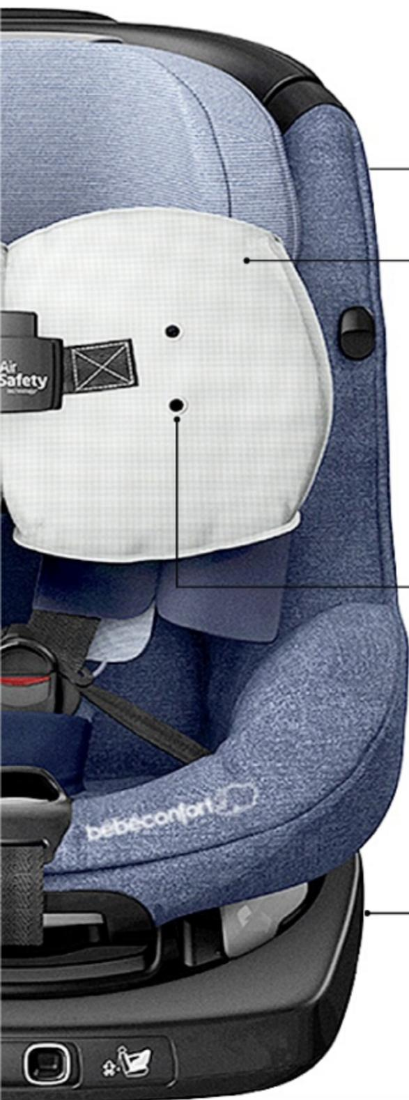
Les deux airbags (ici déployés) sont intégrés aux protège-bretelles du siège. Adaptés aux enfants, ils sont plus petits (20x20 cm) et se déploient moins brutalement que les airbags traditionnels, en se remplissant d'air froid.
