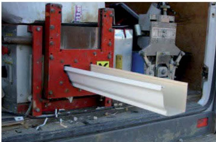
Fig. 7.4 – Profileuse transportable sur camion
