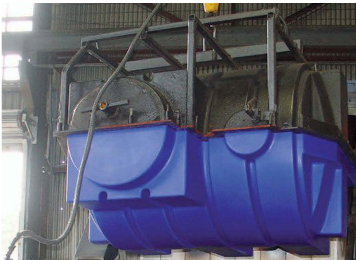
Fig. 2.16 – Fabrication d'une cuve BlueLine en polyéthylène de 9 000 L
