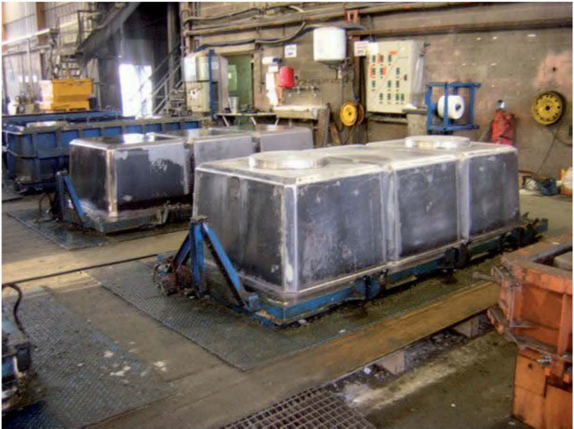
Fig. 2.15 – Moules pour la fabrication des cuves en béton
