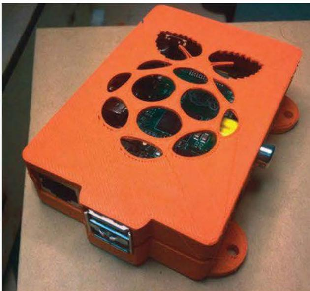
**Figure 1-10.** Boîtier pour le Raspberry Pi (<http://thingiverse.com/thing:25363>)
