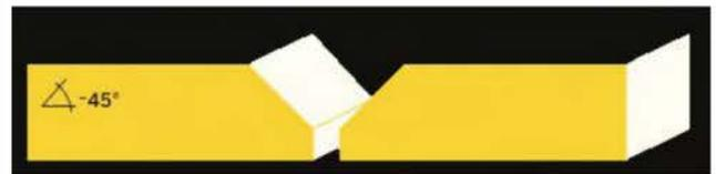
**Figure 13-5.** Biseautez les angles supérieurs de la couture pour former un sillon étroit en forme de V.
