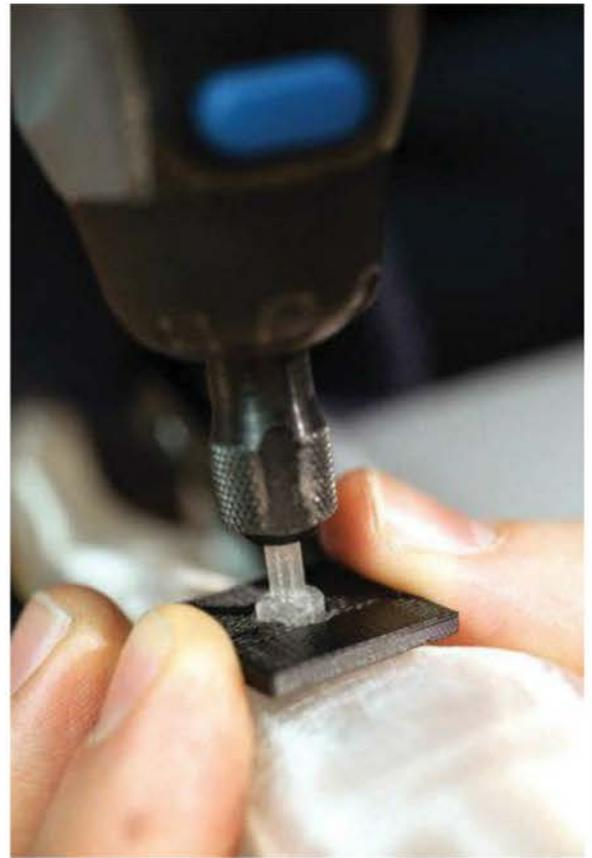
5. Desserrez la vis de l'embout et libérez le rivet aveugle hors du capuchon de l'outil rotatif. Si le rivet continue de refroidir, gardez-le en position jusqu'à ce qu'il ne soit plus chaud. À ce moment-là, il devrait être entièrement fusionné à son point de fixation.
