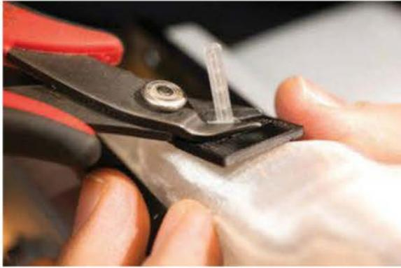
7. Si elle dépasse trop, possède comme une crête pointue ou semble trop étroite pour maintenir le panneau, chauffez-la avec un pistolet à air chaud. Puis, à l'aide de la tête d'un clou en acier, aplatissez-la.
