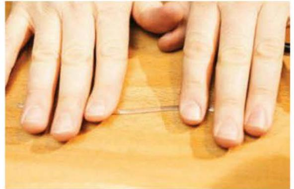
3. Ramollissez un des côtés grâce au pistolet à air chaud réglé sur une température basse – sinon, utilisez éventuellement un fer à souder, une tête en laiton chauffé ou un plateau d'impression chauffé.
