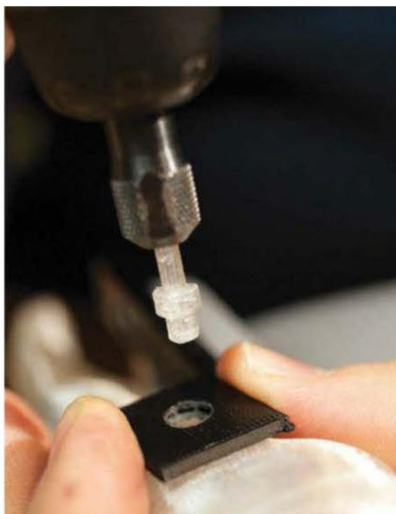
3. Allumez l'outil rotatif et insérez prudemment la tige du rivet à travers le trou de fixation afin qu'elle touche la position de fixation. Continuez à tourner jusqu'à ce qu'elle commence à fondre et à se déformer. Ensuite, appuyez doucement dessus pour qu'elle soit en place.
