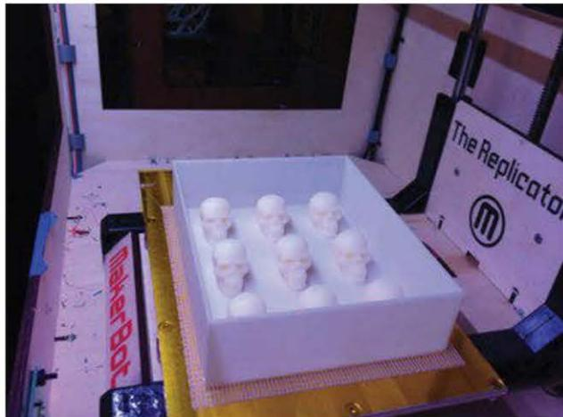
Figure 21-4. Moule fraîchement imprimé en 3D
