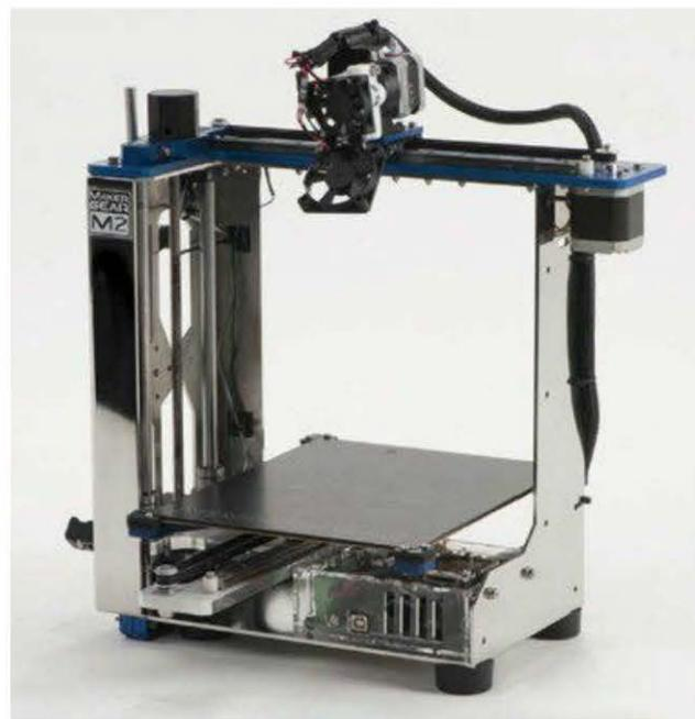
La carte électronique RAMBo UltiMachine, un dérivé amélioré de la populaire RAMPS, contrôle l'imprimante et supporte les doubles extrudeurs. Ainsi, nul besoin de changer l'électronique pour mettre à jour vers des doubles extrudeurs.
