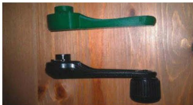
**Figure 16-6.** Pièce de rechange de la manivelle de vitre
