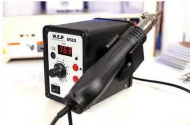
Figure 13-1. Station de travail à air chaud
