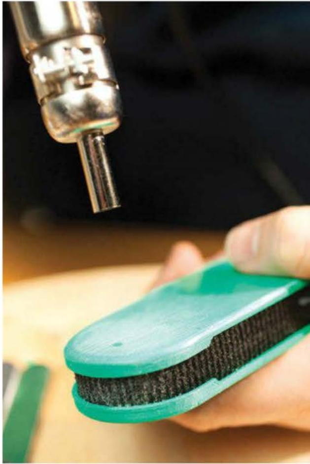
**Figure 13-20.** Un pistolet à air chaud permet de supprimer les petites éraflures.
