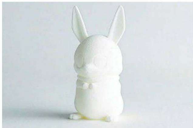
**Figure 9-3.** Poudre de nylon fusionnée par frittage laser sélectif
