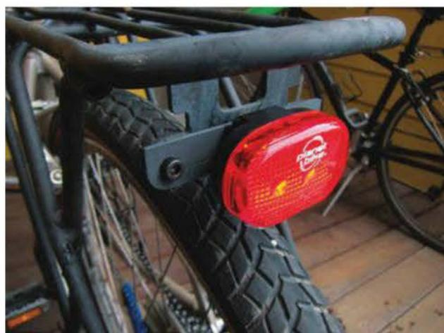
**Figure 16-7.** Attache de l'éclairage arrière
