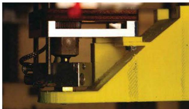
**Figure 1-13.** Ventilateur entouré d'une cale d'espacement (<http://thingiverse.com/thing:16530>)
