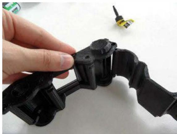
2. Installez l'enveloppe arrière (BackCover) sur son axe et insérez l'écrou et la vis. L'enveloppe arrière devrait bien s'assembler et tourner librement sur son axe. Placez aussi l'arrière de l'obturateur (BackShutter) sur sa rainure sur le corps.
