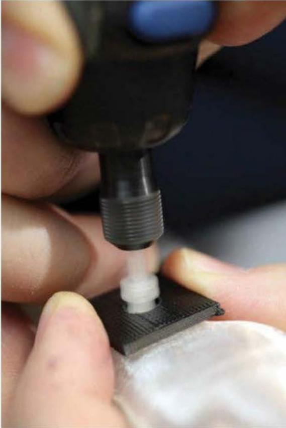
4. Arrêtez l'outil rotatif. Maintenez-le en place fixement et au bon angle, tout en appliquant une petite pression vers l'arrière. Il peut être utile d'utiliser une pièce de carton ou de mousse pour arrêter la friction en stoppant rapidement la rotation. Notez qu'à la différence d'un outil professionnel de rotation-soudage, la plupart des outils rotatifs ont besoin d'une ou deux secondes pour arrêter de tourner.
