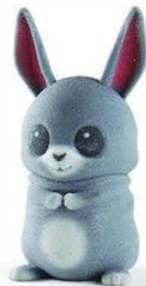
**Figure 9-1.** Grâce à un procédé de lit de poudre/jet d'encre, Bowie le lapin est réalisé à partir de poudre minérale fine, avec des liants colorés.
