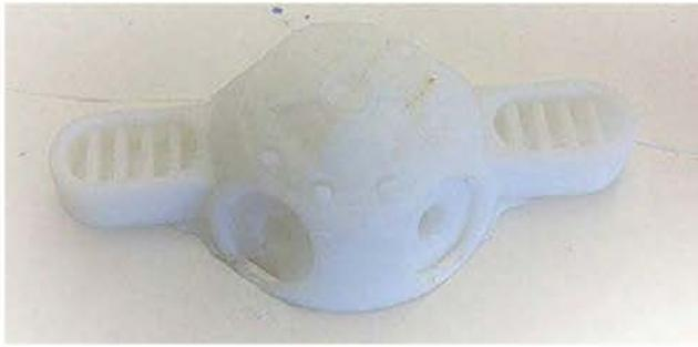
Figure 14-2. Pièce arrière du robot, imprimée en 3D
