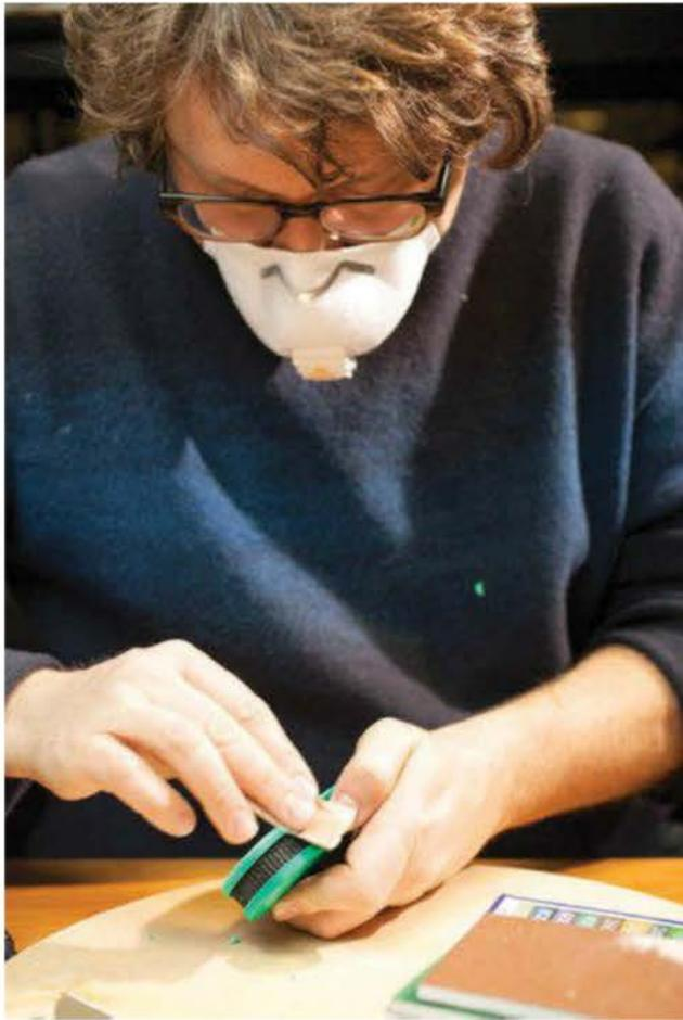
**Figure 13-17.** Ponçage d'une impression 3D
