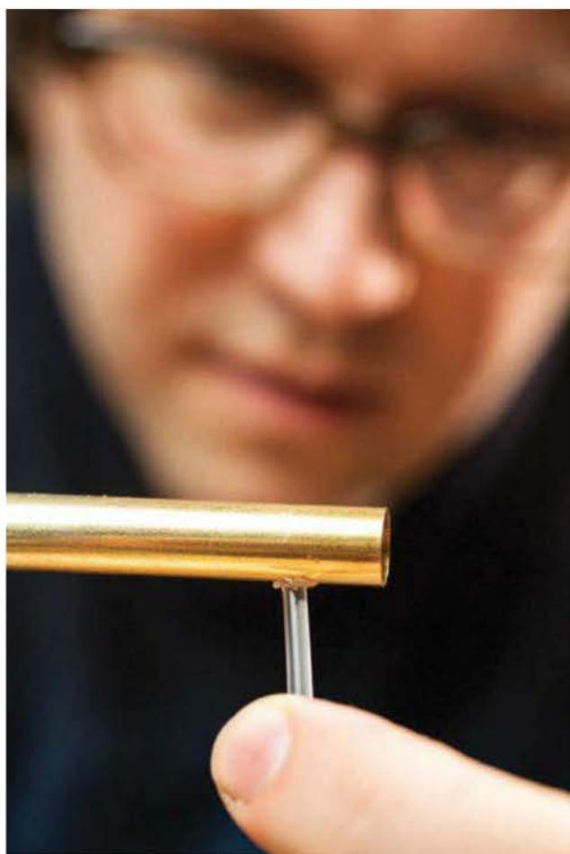
**Figure 13-16.** Protégez le bout du fer avec un tube en cuivre.
