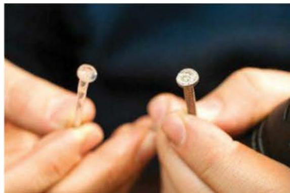
7. Insérez le rivet dans le point de fixation jusqu'à ce que la tête d'usine soit alignée. Coupez ensuite la tige un petit peu après, là où vous aurez la seconde tête du rivet.
