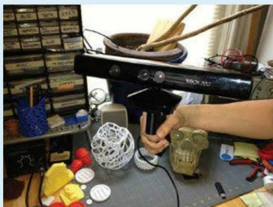
**Figure 6-11.** Une Kinect avec sa poignée
