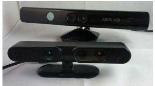
**Figure 6-1.** La Kinect de Microsoft et la Xtion d'ASUS
