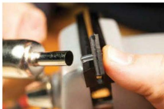
9. Utilisez une surface plane et douce pour la presser et la déformer afin de créer la tête de magasin du rivet. J'ai constaté
