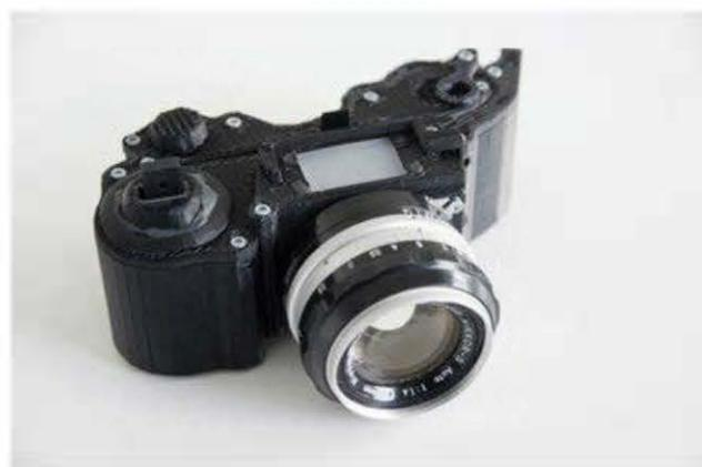
**Figure 23-1.** L'appareil photo OpenReflex imprimé en 3D, de Léo Marius
