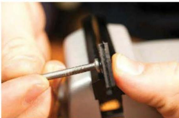
Attention, ne forcez pas sur l'assemblage avant que le rivet et les pièces assemblées aient refroidies à température ambiante. Regardez la figure ci-dessus pour savoir comment maintenir l'ensemble.
