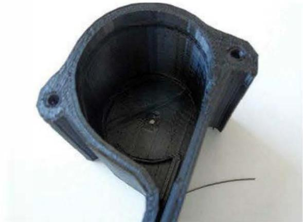
2. Préparez les pièces et placez le roulement sous la roue (Wheel). Il s'encastre précisément. Alignez le roulement sur la rainure, puis poussez. Si du plastique mal imprimé obstrue la rainure, retirez le roulement, nettoyez le trou de la roue et réessayez.
