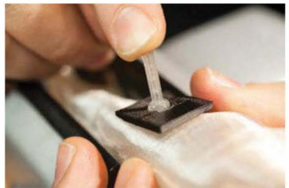
6. Coupez le rivet à l'aide d'une pince coupante. La tête doit rester intacte.
