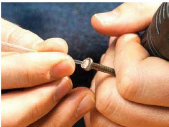
6. Votre rivet devrait avoir une belle tête plate, assez large pour qu'il repose fermement sur les bords du trou de fixation. On parle alors de tête d'usine, par opposition à la seconde tête (ou tête de magasin) qui est créée à l'autre bout lorsque vous installez le rivet.
