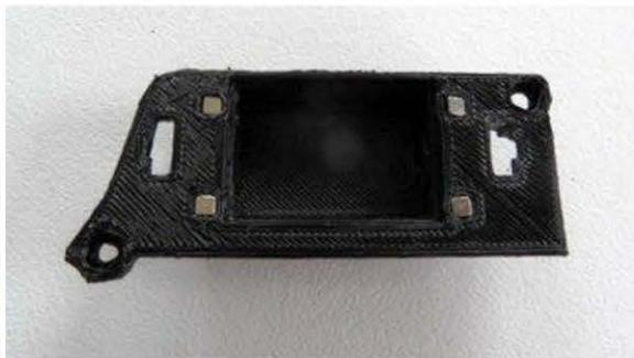
2. Préparez les roulements. Bloquez-les avec une vis et un écrou M3X10. Insérez-les ensuite dans le support du miroir, la tête de la vis orientée vers l’intérieur. Notez que le pont du support du miroir craque parfois ; ce n’est pas grave.
