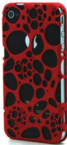
Figure 16-17. Coque d'iPhone imprimée en plastique polyamide rouge
