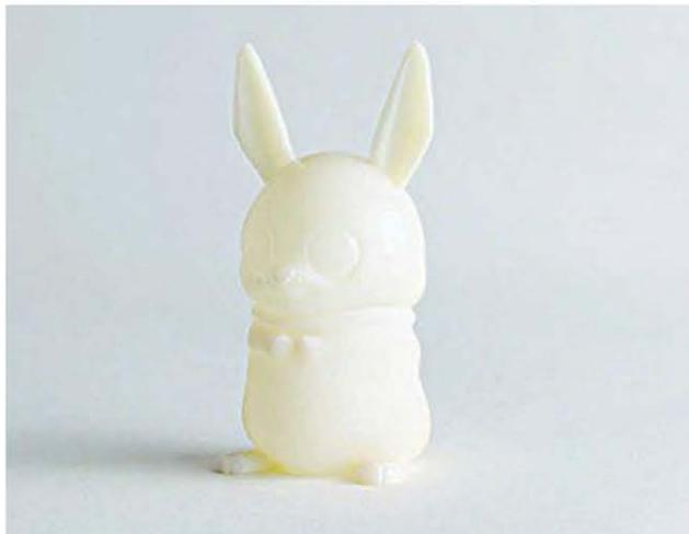
**Figure 9-4.** Acrylique solidifié par UV grâce à la technique de jet de photopolymères
