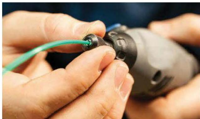
Figure 13-3. Le filament doit être inséré dans l'outil.
