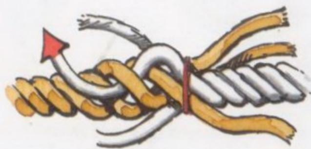
**5** Prenez un toron de la corde de droite. Faites-le passer par-dessus le toron de l'autre corde qui est sous lui, et par-dessous le suivant.
