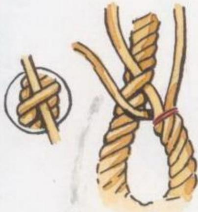
**2** Ouvrez le cordage avec le poinçon ou l'épissoir, et engagez le toron du milieu dans l'ouverture, de la droite vers la gauche.
