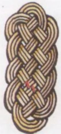
**13** Faites se rejoindre les extrémités au centre de la structure, et stoppez-les par une surliure ou deux nœuds de boa, après les avoir fait disparaître sous un passage. Le dessin nous montre le dessous de l'ouvrage.
