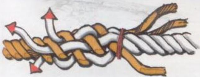
**8** Reprenez chaque toron et refaites un passage par-dessus le toron suivant de l'autre corde, et par-dessous celui d'après.
