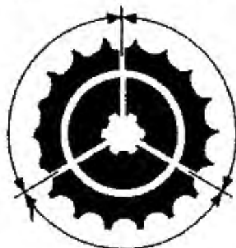
Dent de pignon en bon état
