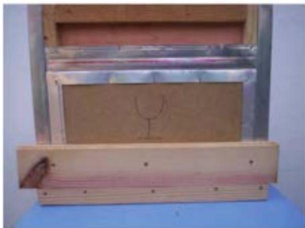
Prenez un premier morceau de planche à parquet ; il sera nécessaire d'enlever la rainure située à l'endroit de la charnière. Percez 3 trous de diamètre 4 dans la planche à parquet et « aspirez », avec des vis, l'autre planche d'aggloméré habillée d'aluminium.
