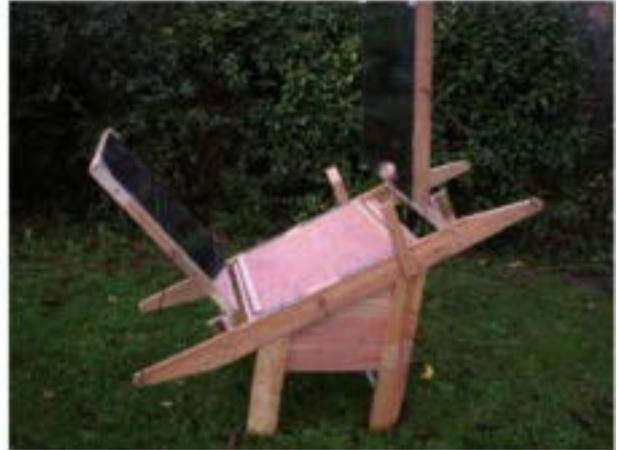
Pour maintenir les déflecteurs dans la position de fonctionnement, reliez-les avec une tige métallique (fer à béton par exemple de diamètre 6). Quelques trous permettront de mettre le déflecteur en bonne place.
