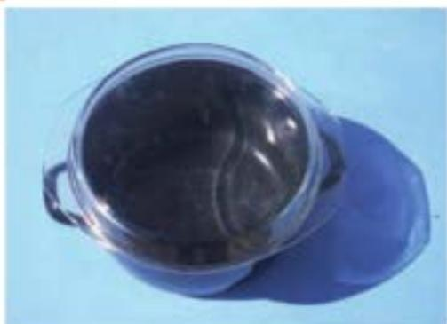
type de couvercle permettra au cuisinier de surveiller sa cuisson contrairement à un couvercle opaque, très frustrant et contraignant lorsque que l'on a besoin d'accéder à la marmite. Pour un utilisateur habitué à « touiller » sa cuisine, ce n'est pas supportable. Par ailleurs, ce couvercle vitré permettra un deuxième effet de serre dans la marmite augmentant davantage la température dans celle-ci, où il fera entre 20 et 50° plus chaud que dans le four.
