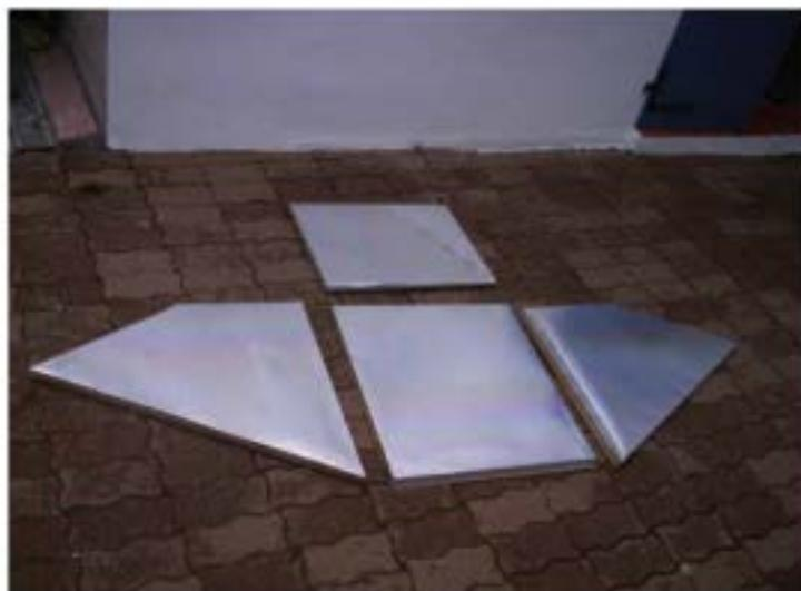
Nous allons maintenant recouvrir chacune de ces pièces avec de l'aluminium en fines feuilles. L'idéal est dans la mesure du possible de récupérer de l'aluminium provenant de plaques offset d'imprimerie. Ces plaques offset ont un côté encré et un côté brillant ; c'est celui-ci qui nous intéresse. S'il est un peu souillé par des traces d'encre, il est facile de le nettoyer avec de la lessive, ou de l'alcool.
