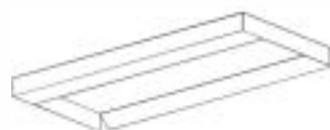
L'habillage d'aluminium se fera par un repli de 20 à 30 cm sur les côtés AM, A'M', et AA'. Sur le côté MM', faites un double repli.
