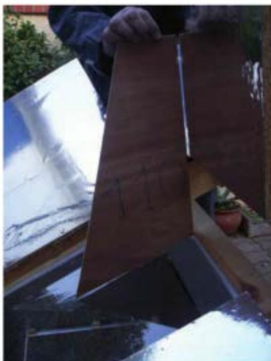
Pour positionner les déflecteurs nord et sud (schéma 60-23-00 et 60-24-00) au bon endroit, vous pouvez vous servir d'un angle de 110° ; comme sur les photos ci-dessus. Mis sous cet angle de 110°, les déflecteurs (nord et sud) seront alignés avec l'arête de la vitre. Par la suite, lorsque vous viendrez orienter ces déflecteurs suivant les positions du soleil, la projection de lumière se trouvera en bonne place.
