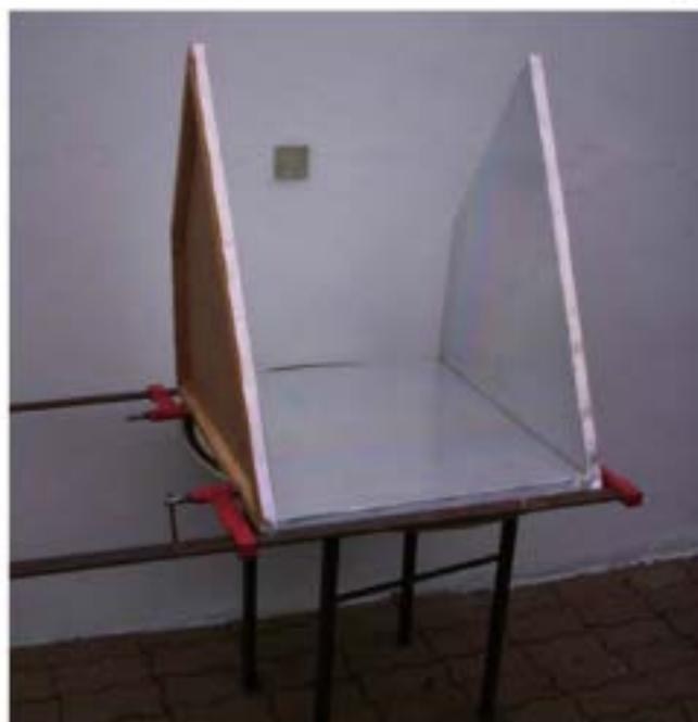
À l'aide de serre-joints, assemblez avec précision le fond et les 2 côtés symétriques. Pour assurer une fixation parfaite vous pouvez percer un trou de :
