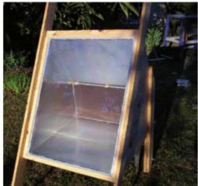
À l'aide de lambris délimités à la scie circulaire, faites des pare-closes horizontales et verticales dans lesquelles viendra se loger la vitre. Un peu de jeu est nécessaire. Le périmètre de la vitre reposera sur 1 cm environ (voir références 60-30-14 de la p. 32 et 60-14-15 de la p. 28). Dans l'angle de ce cadre, déposez un cordon de cartouche silicone neutre. Puis posez la vitre dans son emplacement en appuyant légèrement pour écraser un petit peu ce cordon de silicone.
