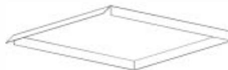
L'habillage d'aluminium se fera en posant le fond de four sur la plaque offset et en laissant un dépassement de 2 à 3 cm sur tous les côtés pour faire les replis.
