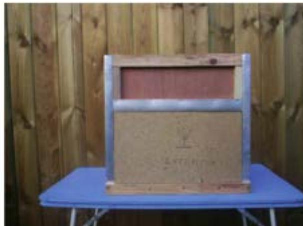
Afin de réaliser le premier morceau (panneau réflecteur), il vous est possible de prendre une chute d'aggloméré (15 à 20 mm d'épaisseur). Pour découper cette chute juste à la dimension de la baie ouverte, il vous suffit de la placer sur le tasseau d'articulation et de faire le traçage en suivant le périmètre intérieur de la baie ouverte. Ainsi, même si la baie ouverte est légèrement déformée, la porte s'adaptera parfaitement malgré les petites erreurs inévitables.
