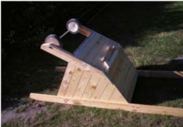
Sur la photo ci-contre, on a utilisé une tige filetée, des écrous, des rondelles pour faire la fixation.
