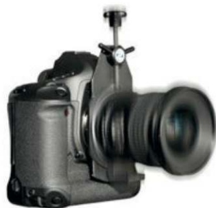
Fig. 2.35 – Utilisation d'un objectif moyen format et d'un adaptateur à décentrement pour décaler l'axe optique et corriger les perspectives
