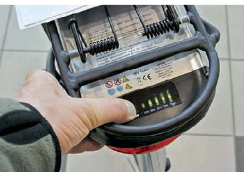
La jauge d'autonomie est également visible à l'arrière de la batterie sur le modèle Wayscral.
