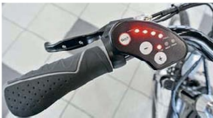
Le tableau de bord doit être lisible, ergonomique, et facilement accessible du pouce.
